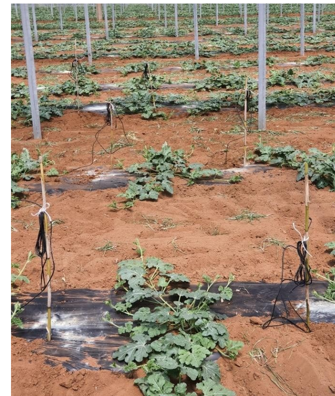
Collocazione delle sonde di umidità nel terreno.
