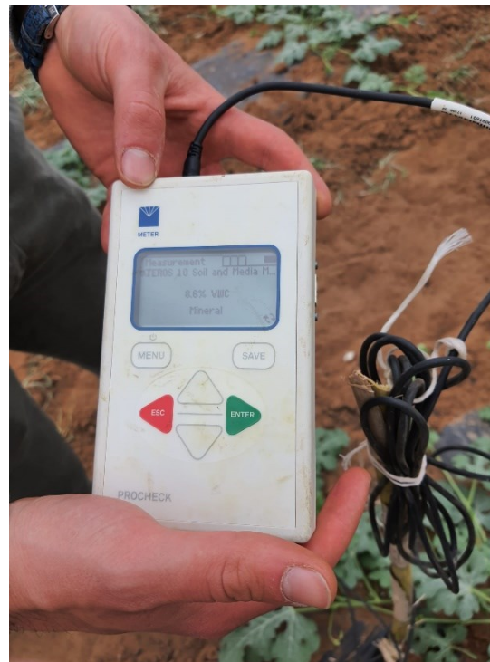
Lettole collegato alle sonde per la rilevazione del contenuto di umidità nel suolo.
